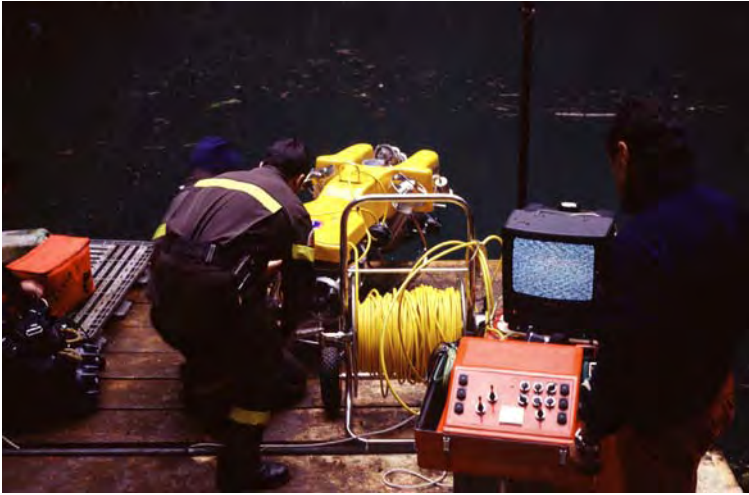
Fig. 3 – I Vigili del Fuoco di Roma si apprestano a mettere in acqua il R.O.V. Mercurio, con il quale il Pozzo è stato esplorato fino a 210 m di profondità (Foto M. Giardini).
