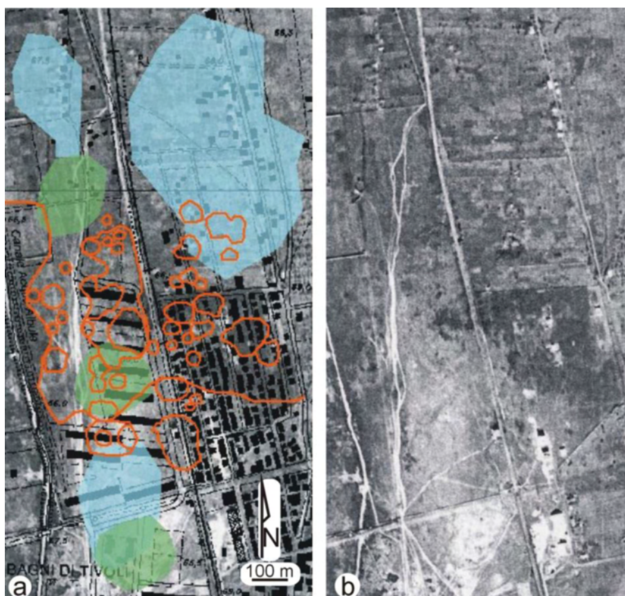
Fig. 12 - (a) Tematismi morfologici creati in ambiente GIS ottenuti dall'analisi della cartografia del Prof. C. Maxia (in celeste: suoli a struttura poligonale di disseccamento lacustre nei travertini; in verde: suoli a "pozzette" e a ripiani tartarosi), e dalle foto aeree della R.A.F. del 1943 (in rosso: aree depresse). (b) Foto aerea della R.A.F. relativa all'area di studio. Da Funicello et al., 2005a e 2005b.
